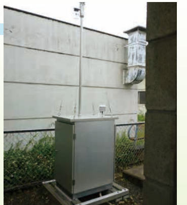
大気中の微小粒子状物質（PM2.5）の自動測定機
