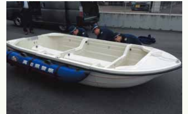
FRP製三分割ボートの組立風景
